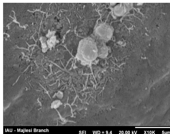
شکل (۷): تصویر تهیه شده توسط SEM از نمونه ۱ آسیاب کاری شده و سپس سنتز شده در دمای 1400^{\circ}\text{C} .
