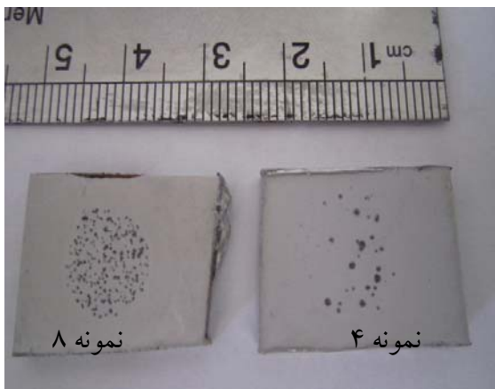
شکل (۸): تصاویر ماکروسکوپی از تعداد و نحوه حفره‌ها در سطح نمونه‌های مربوط به آزمایش ۲ و ۴ تاگوجی پس از آزمون پلاریزاسیون
