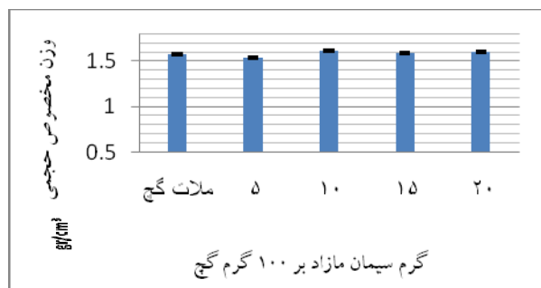
شکل (۶): نمودارهای ستونی تغییرات وزن مخصوص حجمی حاصل از افزودن سیمان به گچ
