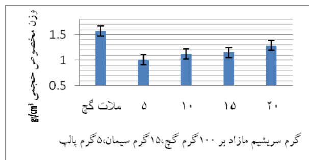
شکل (۹): نمودارهای ستونی تغییرات وزن مخصوص حجمی حاصل از افزودن سریشیم به ترکیب ۱۰۰ گرم گچ، ۱۵ گرم سیمان و ۵ گرم پالپ
