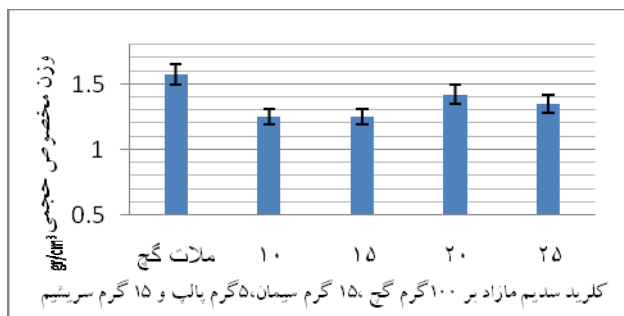
شکل (۱۶): نمودارهای ستونی تغییرات وزن مخصوص حجمی حاصل از افزودن کلرید سدیم به ترکیب ۱۰۰ گرم گچ، ۱۵ گرم سیمان، ۵ گرم پالپ و ۱۵ گرم سربیشیم
