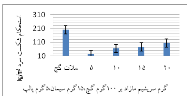
شکل (۸): نمودارهای ستونی تغییرات استحکام شکست سرد حاصل از افزودن سریشیم به ترکیب ۱۰۰ گرم گچ، ۱۵ گرم سیمان و ۵ گرم پالپ
