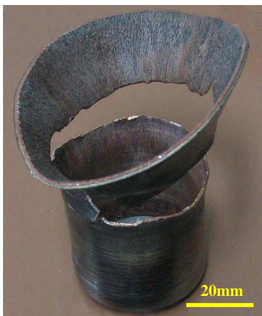
شکل (۱۵): قطعه دولایه تولید شده با نسبت اسپینینگ ۲.۶
