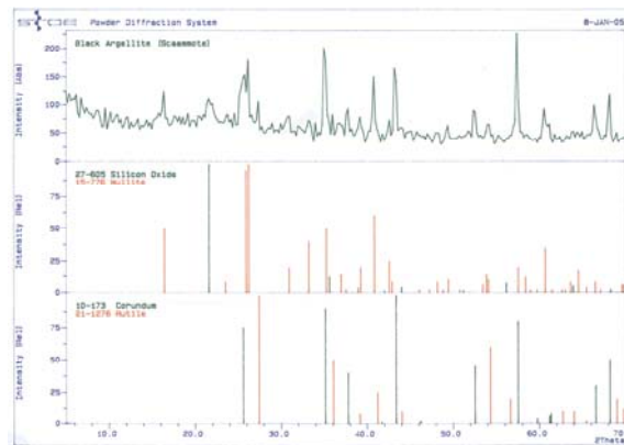
شکل ۴- آنالیز فازی شاموت آرزلیت پخته شده در دمای ۱۲۰۰ درجه سانتیگراد با روش XRD که حاکی از وجود فازهای سیلیس، مولیت، کراندوم و روتیل می‌باشد.
