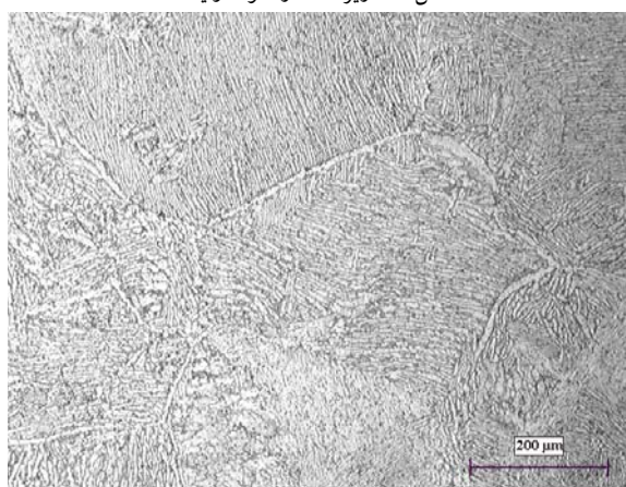
شکل (۳): ریز ساختار نمونه اولیه آنیل شده
