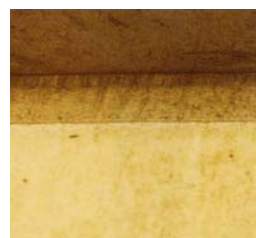
شکل (۹): نمونه ۱,۲۶۷۸ نیتروره به مدت ۱۸ ساعت در ۵۵۰°C
