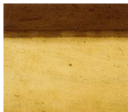
شکل (۴): نمونه ۱,۲۶۷۸ نیتروره به مدت ۱۲ ساعت در ۵۰۰°C
