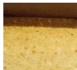
شکل (۶): نمونه ۱,۲۶۷۸ نیتروره به مدت ۱۲ ساعت در ۵۵۰°C
