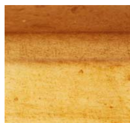
شکل (۷): نمونه ۱,۲۳۶۷ نیتروره به مدت ۱۲ ساعت در ۵۷۰°C
