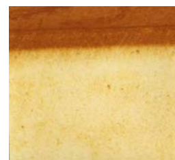
شکل (۵): نمونه ۱,۲۳۶۷ نیتروره به مدت ۱۲ ساعت در ۵۵۰°C
