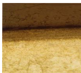
شکل (۸): نمونه ۱,۲۶۷۸ نیتروره به مدت ۱۲ ساعت در ۵۷۰°C
