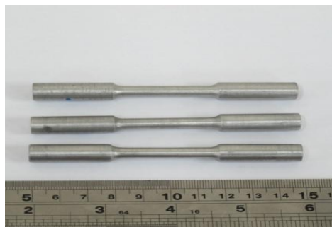
شکل (۲): قطعات آماده شده جهت انجام آزمایش استحکام کششی
