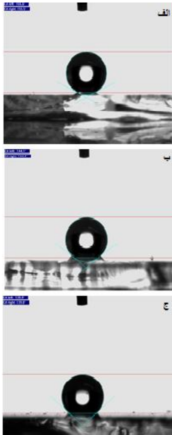
شکل (۱۱): قطره آب بر روی سطح نانومیله‌های همراه ZnO با ضخامتهای بذرلایه: (الف): ۵۰nm، (ب): ۱۵۰nm و (ج): ۳۰۰nm
