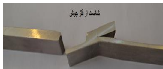
شکل (۸): محل شکست نمونه جوشکاری شده با ارتفاع هوک زیاد
